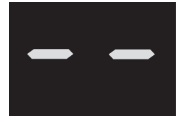
Fig. 60 Affichages du four (G) et de la table de cuisson (D) en mode sabbat
