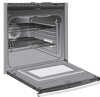
Figure 32 : Dépose de la porte
