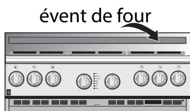
Figure 11 : Emplacement de l'évent de four
