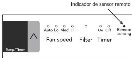
NOTA: La pantalla de la unidad muestra la temperatura configurada
