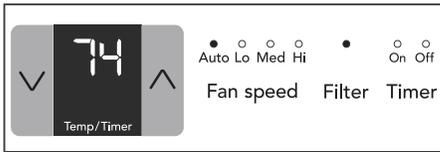
Nota: Esta función es un recordatorio para limpiar el filtro de aire (vea "Cuidados y limpieza") para conseguir un rendimiento más eficiente. El LED (luz) se iluminará después de 250 horas de operación. Para reestablecer después de limpiar el filtro, oprima el botón "Filter Reset" y la luz se apagará.
