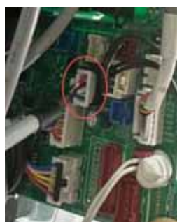
5. Retire la placa del circuito impreso (PCB) y desenchufe el sensor de pérdida de refrigerante del CN3.
