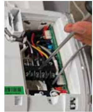
4. Retirez 1 vis pour retirer le bornier (modèles GS06WP2BE* seulement).
