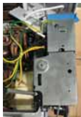
4. Retire la tapa de la caja eléctrica.
