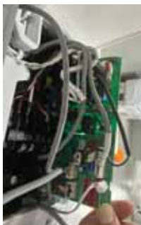
5. Retire la placa del circuito impreso (PCB) y desenchufe el sensor de pérdida de refrigerante del CN3.
