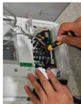
4. Retirez 1 vis pour retirer le bornier (modèles GS06WP2BE* seulement).
