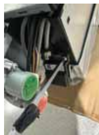
5. Retirez le capteur de fuite.
