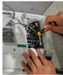
4. Retire 1 tornillo para quitar el bloque termina (modelos QS06WP2BE* únicamente).
