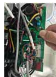
6. Retirez la carte de circuit imprimé et débranchez le capteur de fuite de réfrigérant du connecteur CN3.
