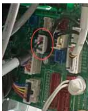
5. Retirez la carte de circuit imprimé et débranchez le capteur de fuite de réfrigérant du connecteur CN3.
