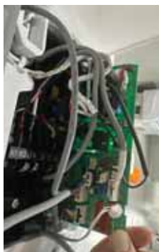
5. Retirez la carte de circuit imprimé et débranchez le capteur de fuite de réfrigérant du connecteur CN3.
