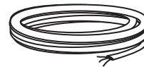
Circuit de dérivation 120 V 60 Hz. 15 ou 20 ampères, 2 fils avec mise à la terre, correctement mis à la terre.
